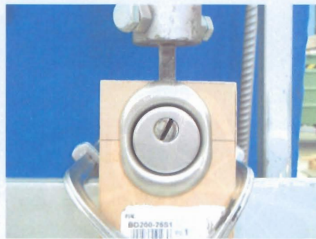
Fotografie delle protezioni del cilindro sottoposte a prova di attacco con scalpello.
