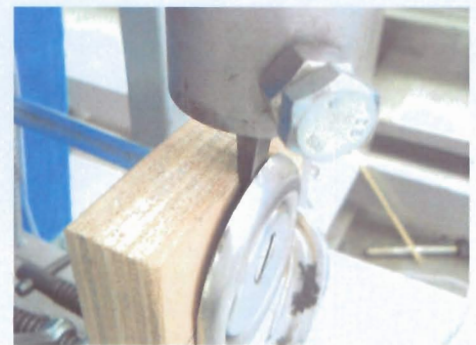
Fotografie delle protezioni del cilindro sottoposte a prova di attacco con scalpello.
